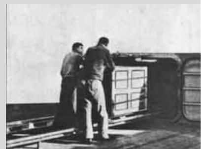
El sistema Palletflo de una linea de empuje para embarque (Shipboard Palletflo Pushline) mueve las cargas sin el uso de autoelevadores. Aquí vemos una plataforma de carga de 1.800 kg que es ingresada en un contenedor.
