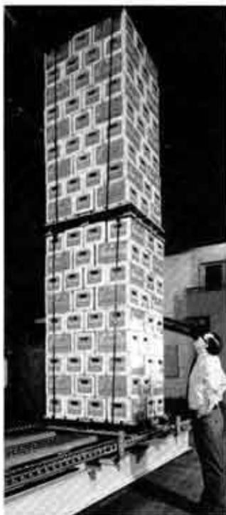
Prova di trasporto su «PALLETFLO» di due pallets carichi di scatole di birra con altezza di m. 5,20 e peso di Kg. 3200. Questa installazione prevede di movimentare grandi unità di carico.
