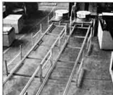
I carichi, i pallets, le ruote, lo spazio fra le ruote e l'inclinazione sono «PALLETFLO» ed hanno un'alta isteresi, le ruote a sinistra non hanno isteresi.
