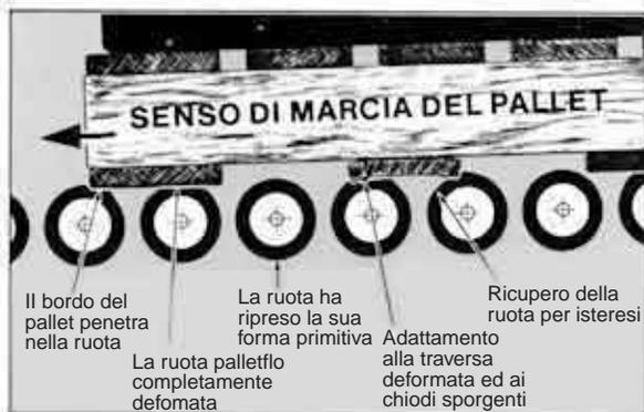
Le ruote «PALLETFLO» sono resilienti e permettono alle irregolarità di passare attraverso la ruota anziché scavalcarla. Il risultato è una minore pendenza e velocità perfettamente regolare.
