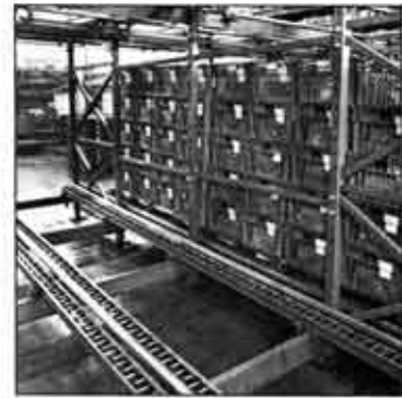
Binari speciali «PALLETFLO» movimentano contenitori in plastica.
