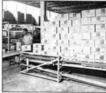
Prelievo ordini direttamente dai pallets. In questo impianto è previsto il ritorno dei pallets vuoti. In questo modo viene garantita all'operatore la sicurezza non essendovi interferenza con i mezzi in movimento. L'operatore colloca le scatole prelevate dai pallets su di un convogliatore che trasporta il materiale in zona di spedizione.
