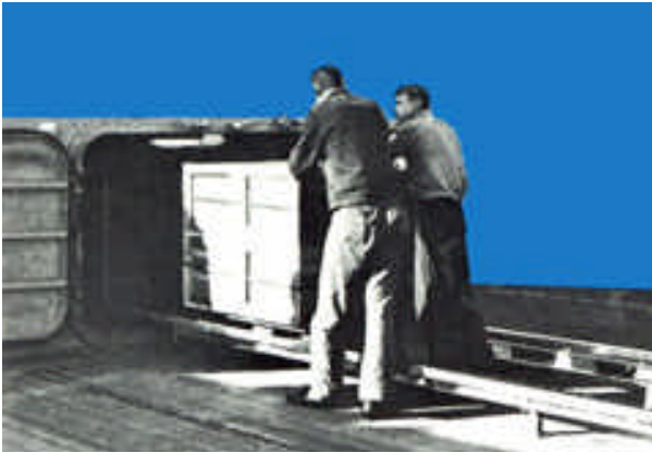
Palettsystem zum Beladen von Containern.
